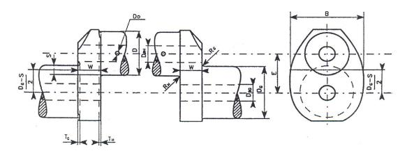
Fig.7 : Crank dimensions
